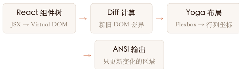
图 28 图 9-3: Ink 的虚拟 DOM 终端渲染流程
