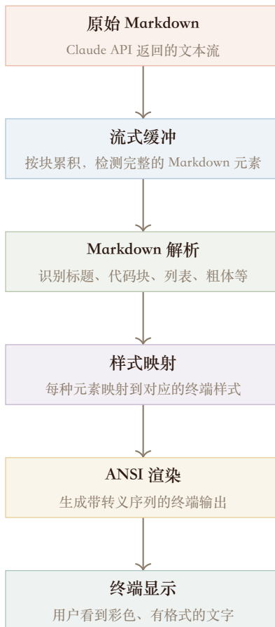
图 26 图 9-1: Markdown → 终端彩色输出的渲染管线
