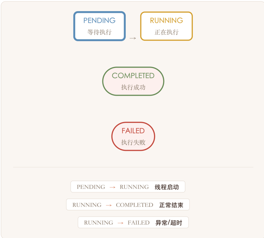
图 14 图 5-2: 后台任务的状态流转
