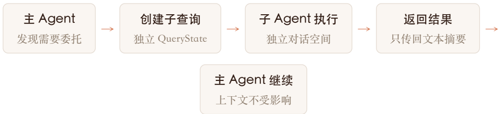
图 13 图 5-1: 委托模式的执行流程
