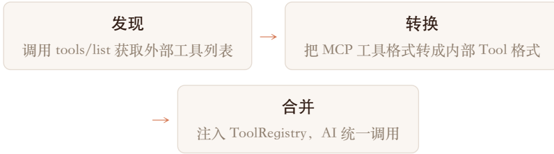
图 23 图 8-2: MCP 工具发现与合并流程
